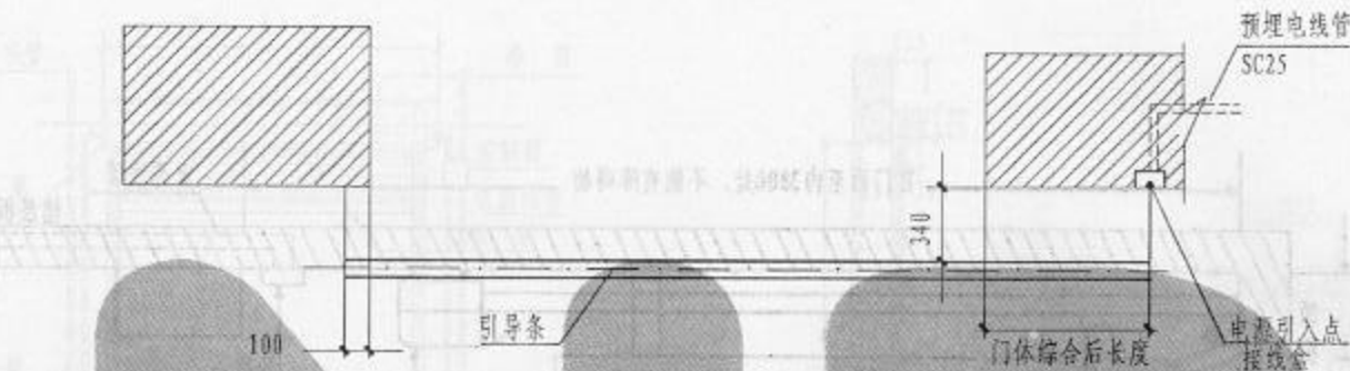
无轨单开门有掩墙示意图
